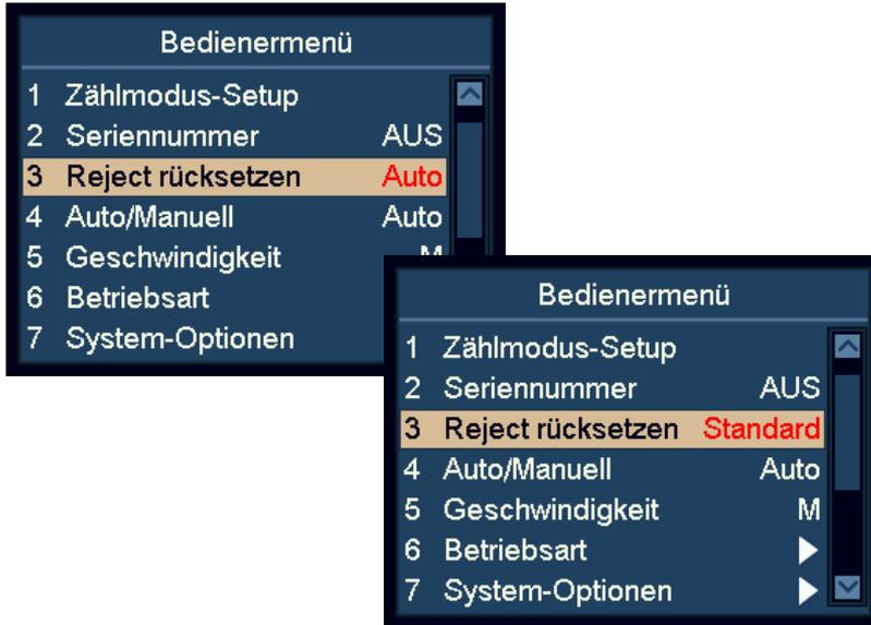
Wenn „Auto“ aktiviert ist, löscht die Maschine die Rückweisungszahl automatisch, sobald die Banknoten aus dem Rückweisungsfach genommen werden, selbst während die Maschine noch weiter zählt.
